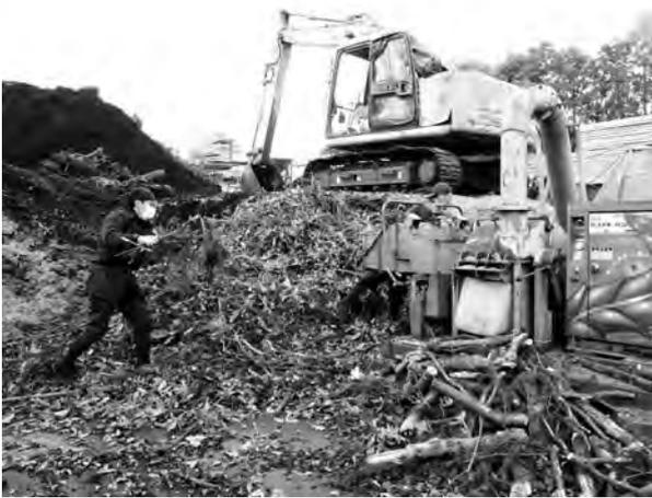
剪定された枝葉を専用の機械（右）で粉碎
